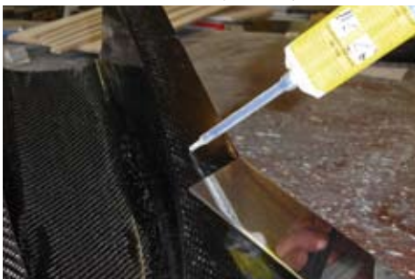
Verkleben von Edelstahl und Karbon im Yachtbau
